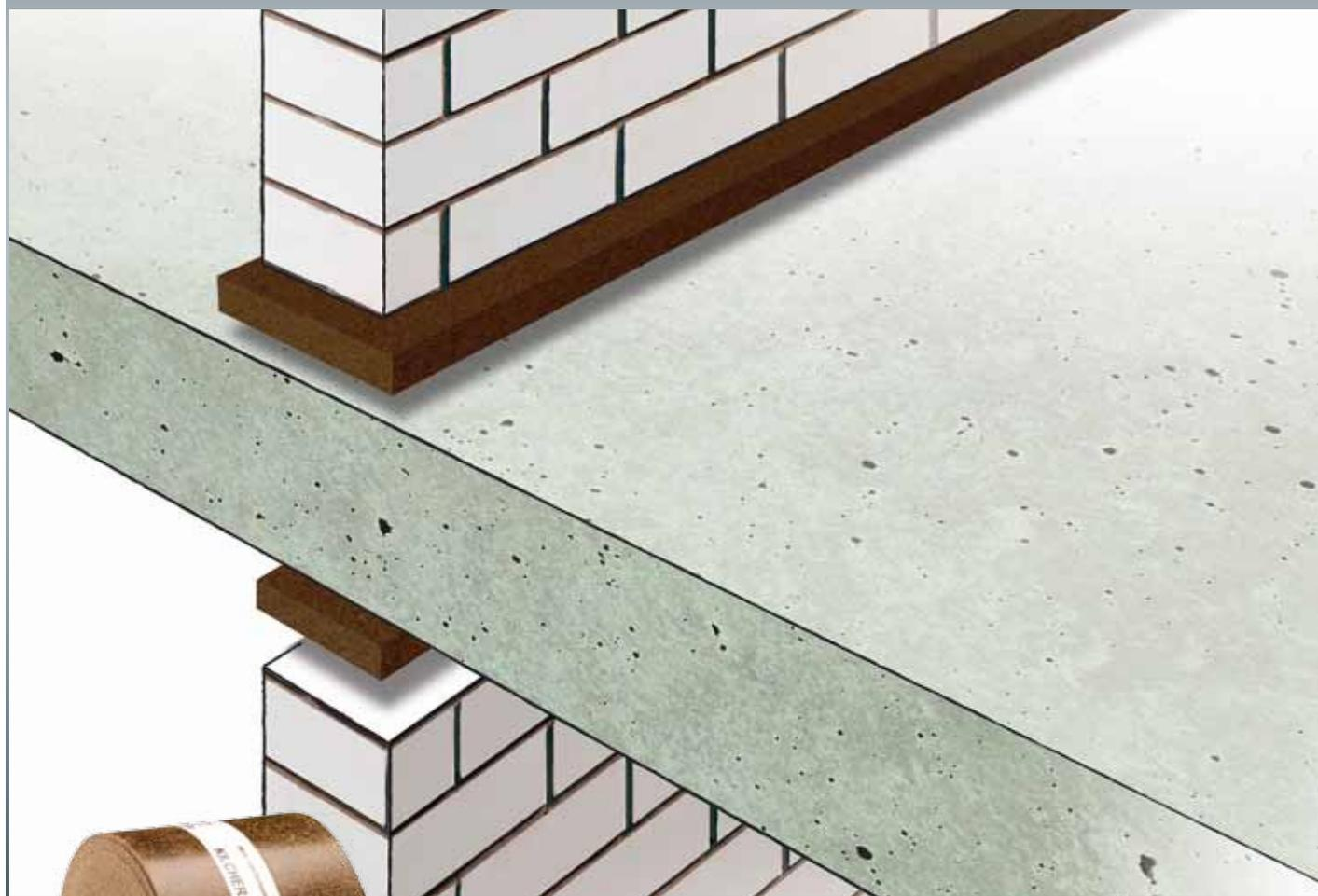
**Il nuovo appoggio per muri e per solette Kilcher Resokork, grazie al buon comportamento statico, consente di ottenere il trasferimento di carichi elevati e al tempo stesso un ottimo isolamento dai rumori trasmessi per via solida.**
