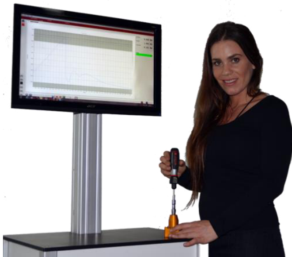
Kalibriereinrichtung für Drehmoment-Schraubendreher
