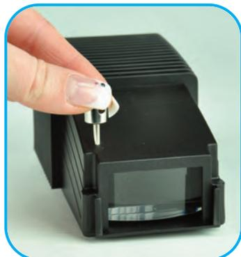
Durch meine schwenkbare Kondensorlinse wechseln Sie in Sekundenschnelle von divergentem zu parallelem Licht
