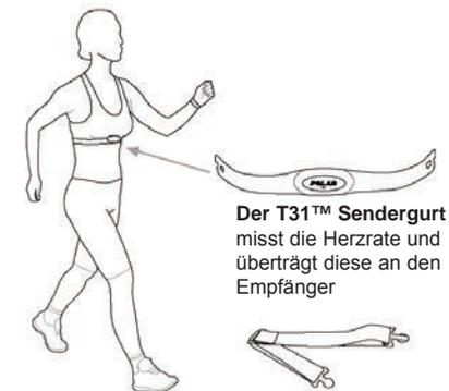
**Der T31™ Sendergurt** misst die Herzrate und überträgt diese an den Empfänger
