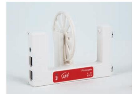
Das Speichenrad kann durch eine Endlos-Schnurverbindung mit einem weiteren Rad auch zur Messung von Rotationsbewegungen verwendet werden.
