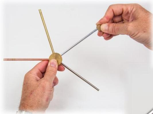
Der Wärmeleitungsapparat wird am Zylinder in der Mitte fest gehalten.
