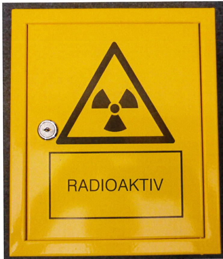
Abbildung 5 Ansicht der Aufbewahrungseinrichtung (b = 21,6 cm; h = 25,6 cm, t = 8,3 cm)
