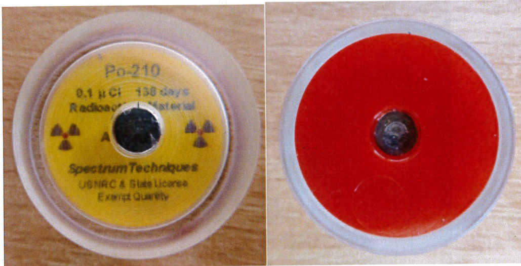
Abbildung 3 Ansicht der ^{210}\text{Po} Strahlenquelle im Epoxybehälter (links: Rückseite mit Magnethalterung in der Mitte; rechts: Strahlenaustrittsbereich in der Mitte).
