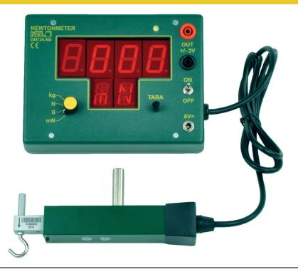
Das Newtonmeter "inno" dient zur Messung von Kräften und von Gewichtskraft verursachenden Massen.
