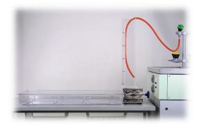
Der Schlauch wird an einen Wasserhahn angeschlossen und das freie Ende in das Ausflussgefäß gehängt.
