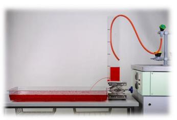
Sinkt der Wasserspiegel im Gefäß, werden auch die Wurfweiten geringer.
