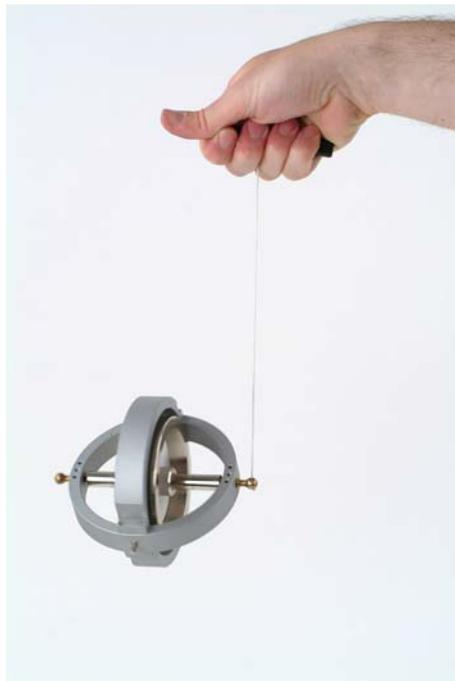
**Ergebnis:** Der Kreisel fällt nicht, wie vielleicht zu erwarten wäre, in Richtung Boden. Die Achse bewegt sich anfangs annähernd in einer Ebene auf einer Kreisbahn. Die Schnur und die Achse behalten bei dieser Bewegung den Winkel bei, den sie vor dem Loslassen eingeschlossen haben.
