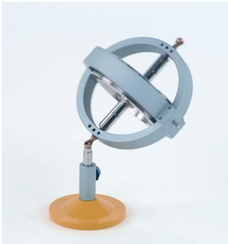
**Ergebnis:** Der Kreisel fällt nicht zu Boden. Die Kreiselachse bewegt sich auf einem so genannten Präzisionskegel.
