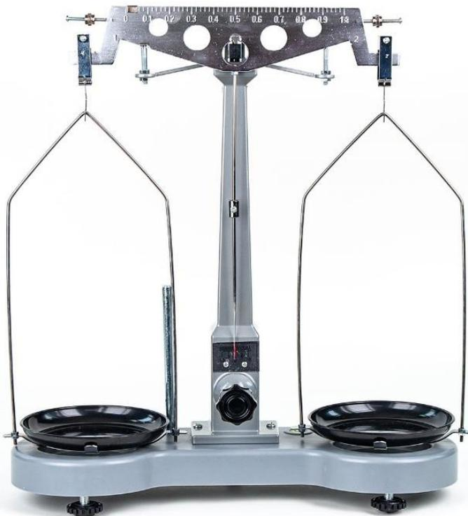
Auf die Schneide an der rechten „2er“-Seite des Hebels wird in denselben Schritten wie zuvor die komplette „2er“ Waagschale gehängt.
