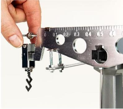
Auf die Schneide an der linken „1er“-Seite des Hebels wird der mit ebenso „1“ markierte Aufhänger aufgelegt.
