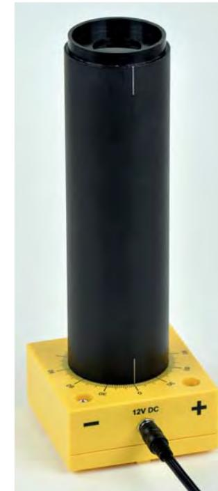
Ein Polarimeter dient zur Messung der Drehung der Polarisationssebene von linear polarisiertem Licht durch optisch aktive Substanzen. Der gemessene optische Drehwinkel  $\alpha$  ist von der intrinsischen Eigenschaft der untersuchten Substanz und deren Konzentration abhängig. Polarimeter werden oft zur quantitativen Bestimmung der Konzentration von optisch aktiven Stoffen in Lösungen verwendet, wie beispielsweise zur Bestimmung des Zuckergehalts einer wässrigen Lösung (Saccharimetrie).
